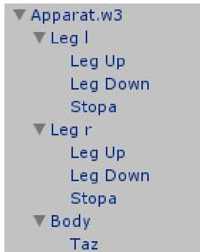
Рисунок 4.2 – Логічна структура моделі крокуючого апарата у середовищі Unity
