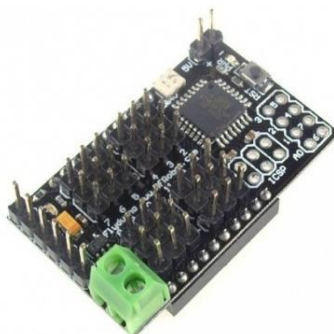
Рисунок.1.8 – Зовнішній вигляд драйвера Flyduino [4]
