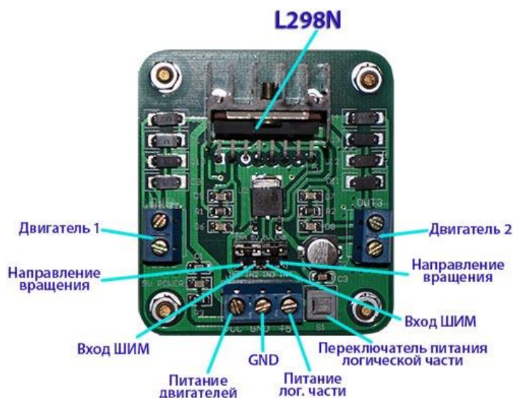
Рисунок.1.6 – Розташування елементів драйвера на L298N [3]
